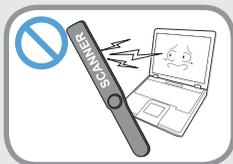
避免将磁盘驱动器暴露在磁场。带有磁场的安全设施包括机场使用的各种设备和安全棒。检查随身携带的行李的机场安检设施，如输送带，使用 X 射线而不用磁力，这样不会损坏驱动器。
