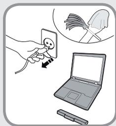
清洁计算机之前，断开所有与计算机相连的电缆。如果您的笔记本属于外部电池和可卸除电池的类型，请卸下外部电池。
