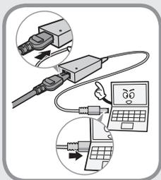
请将电源线牢牢连接到交流电适配器。否则，由于接触不良，会有火灾危险。
