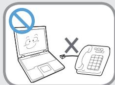
不要将与数字电话相连的电话线连接到调制解调器。
