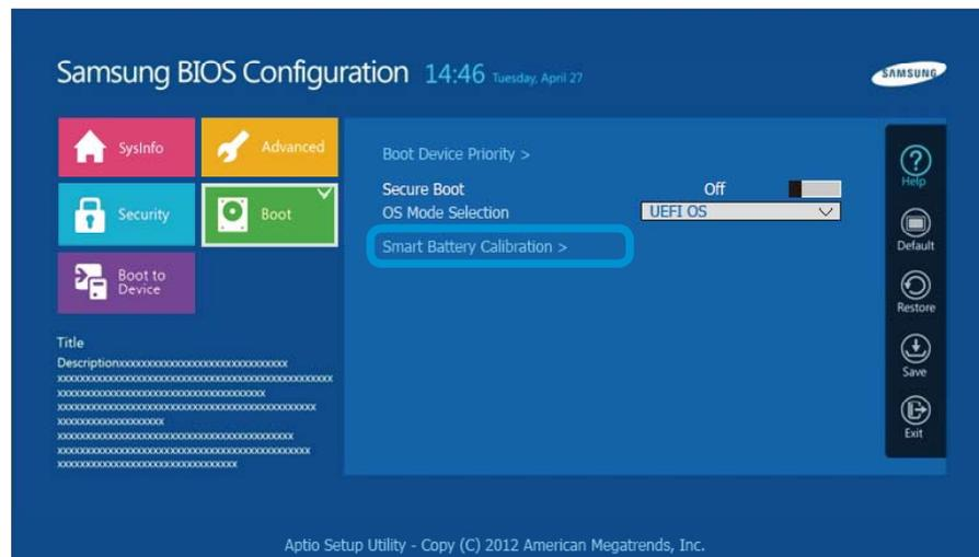
将激活电池校准功能，并强行对电池进行放电。要停止放电操作，请按 **<Esc>** 按钮。
