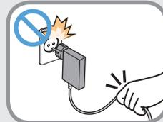
如果通过拖拽电缆来拔出适配器，可能会导致适配器损坏，因而引发触电、爆炸声或电火花。
