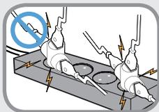
将多头插座或电源插座外延用于本产品时，不要超过标准容量(电压/电流)。
