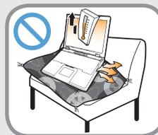
在床上或衬垫上使用计算机时，避免堵塞计算机底部或侧部的通风孔。
