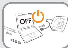
在升级计算机之前，请确保首先关闭计算机电源，然后断开所有连接的线缆。如果笔记本电脑具有外部类型（可拆除）电池，也请卸下电池。
